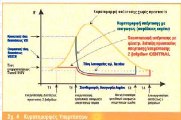
Σχ. 4 Καταστροφές Υπερτάσεων
